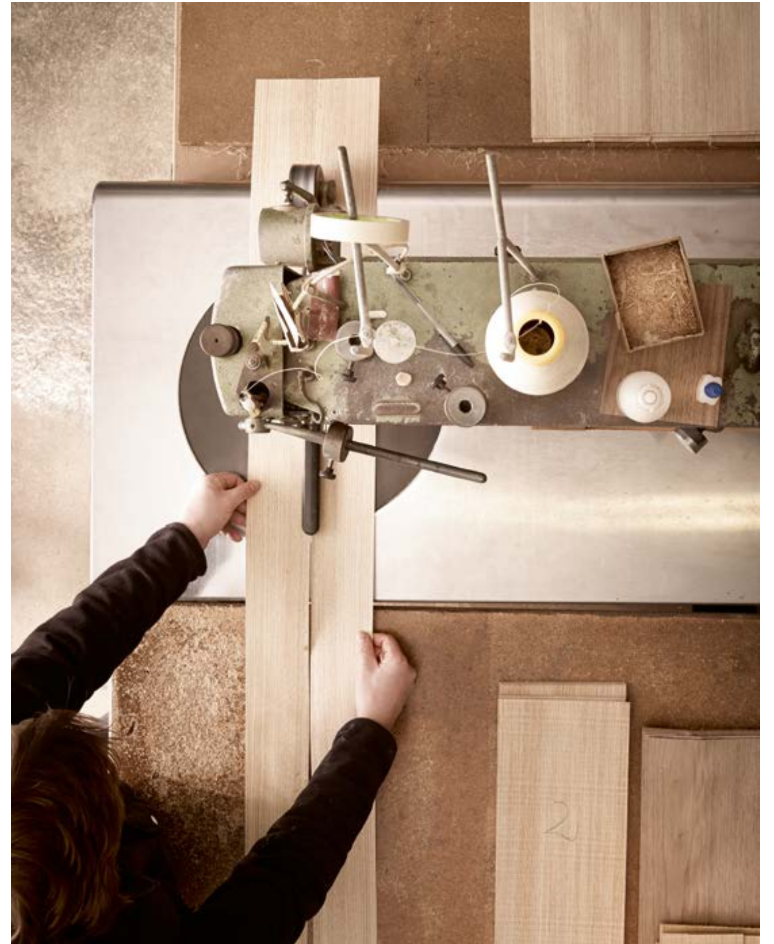
Sewing process of wood sheets. We support FSC sustainable wood sourcing Proceso de cosido de láminas de madera. Utilizamos maderas de bosques de tala controlada con sello FSC
